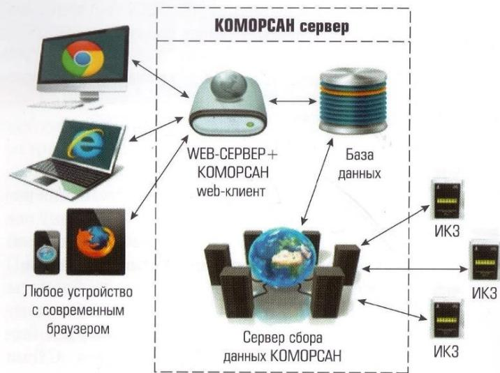
Рис. 18. Структурная схема ПАК КОМОРСАН
