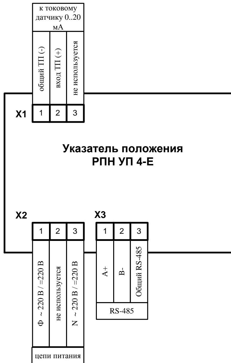
Рис. 3.1 Схема подключения УП 4-Е
