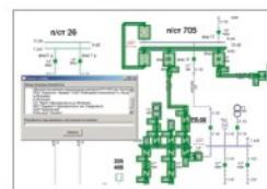
Программно-аналитический комплекс ОДС Софт, работающий с системой телемеханики МАКС-Т, предназначен для улучшения работы оперативно-диспетчерского персонала путем информирования о текущем состоянии схемы электроснабжения, потреблении и потерях электроэнергии и состоянии оборудования, помощи в решении расчетно-аналитических задач управления режимами системы электроснабжения, инженерным персоналом производственных служб. Основная функция комплекса – расчет режимов работы энергосистемы.
